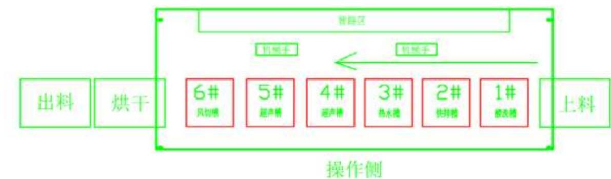
烘干线 → 吹干槽 → 超声槽 → 超声槽 → 热水槽 → 快排槽 → 酸洗槽 → 进料线 → 工艺流向
